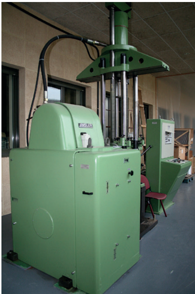
Figura 6. Máquina de 0.5MN para ensayos de fatiga.
