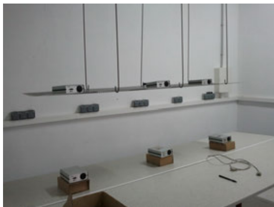
Figura 7: Posiciones de monitores de radón dentro de la sala de exposición para estudiar la homogeneidad.
