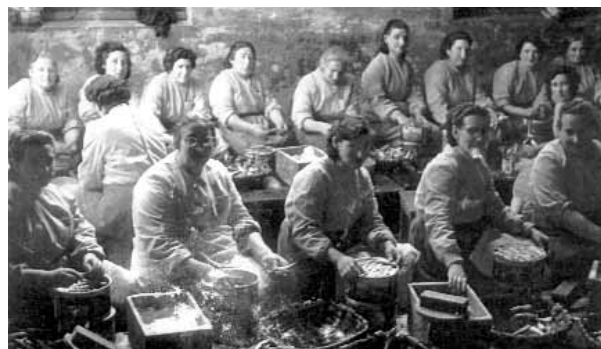
Obreras trabajando salazón en la factoría de Salvatore Orlando. Años cincuenta. En la imagen se pueden observar los saleros y los cestos así como la tapa que servía para presionar manualmente la anchoa. Documento fotográfico amablemente cedido por Alfonso Orlando Castañeda.
