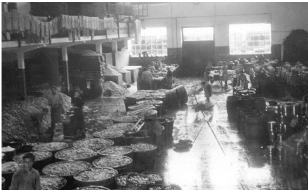
Imagen del interior de la fábrica de Lo Coco en los años sesenta. En el centro se pueden observar las tinas repletas de anchoa y a la izquierda los montones de anchoa salada en el mismo suelo a la espera de habitáculos donde poder sumergirlos en salmuera. En la parte superior se ven colgados los trapos utilizados para secar la anchoa en el fileteado. Archivo gráfico de Santoña. Foto cedida por Alberto Lo Coco Irazola.
